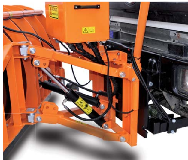
Pług mocowany jest na nośniku za pomocą solidnej płyty DIN typu A
