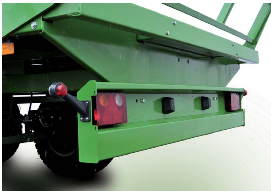
Tylne zabezpieczenie najazdowe zintegrowane z tylnym oświetleniem
