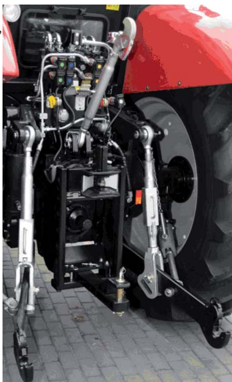
3-punktowy układ zawieszenia w ciągniku PRONAR 5130 serii P5
