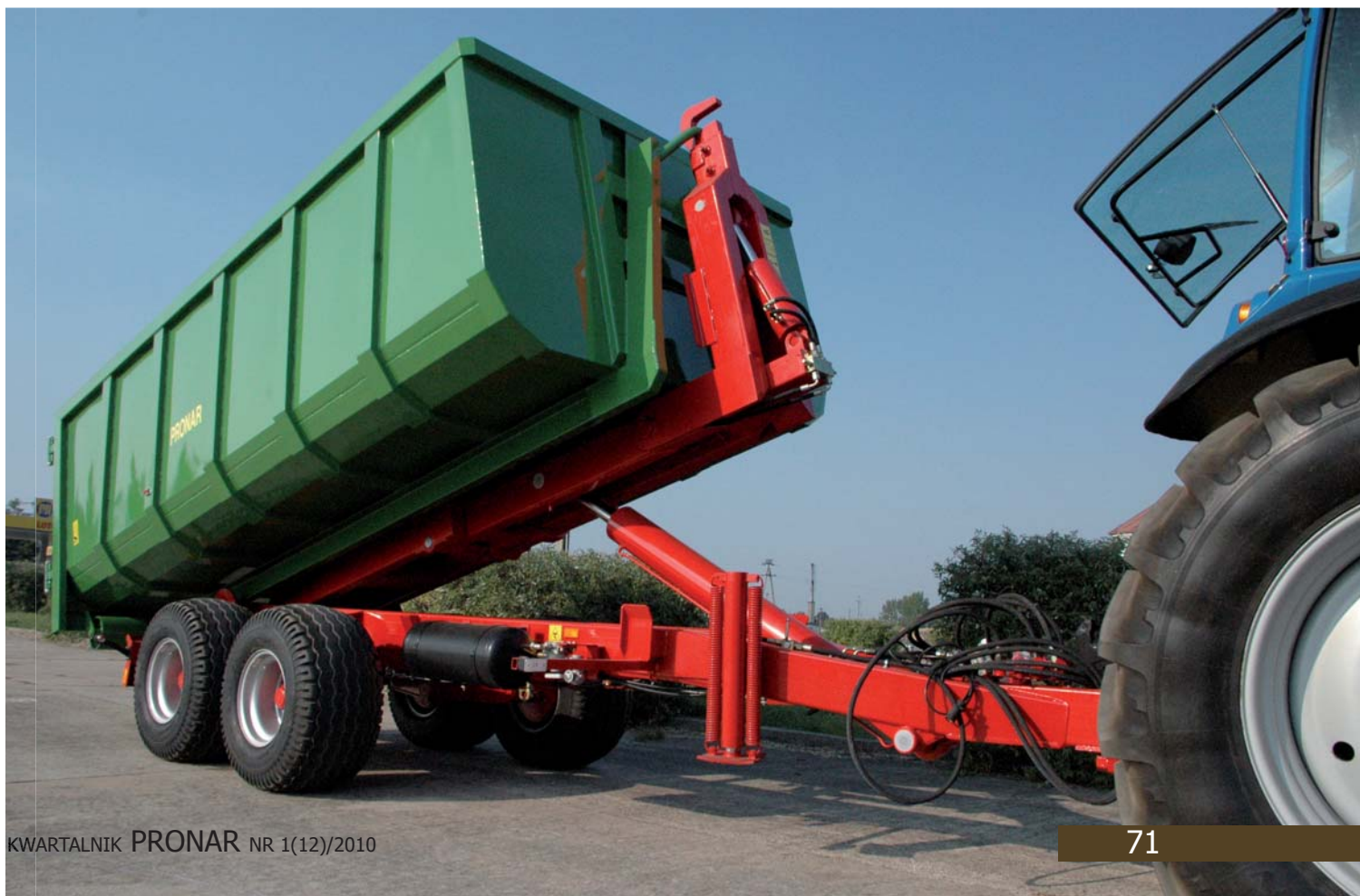
Zastosowanie siłowników w przyczepie PRONAR T285
