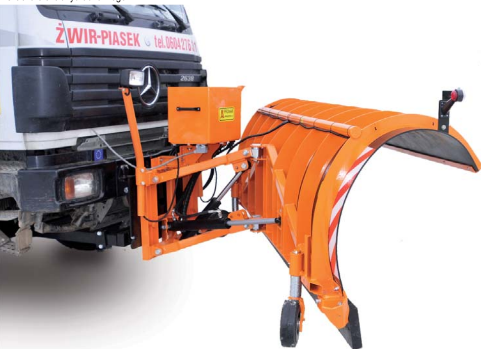
Pług mocowany jest na nośniku za pomocą solidnej płyty DIN typu A
