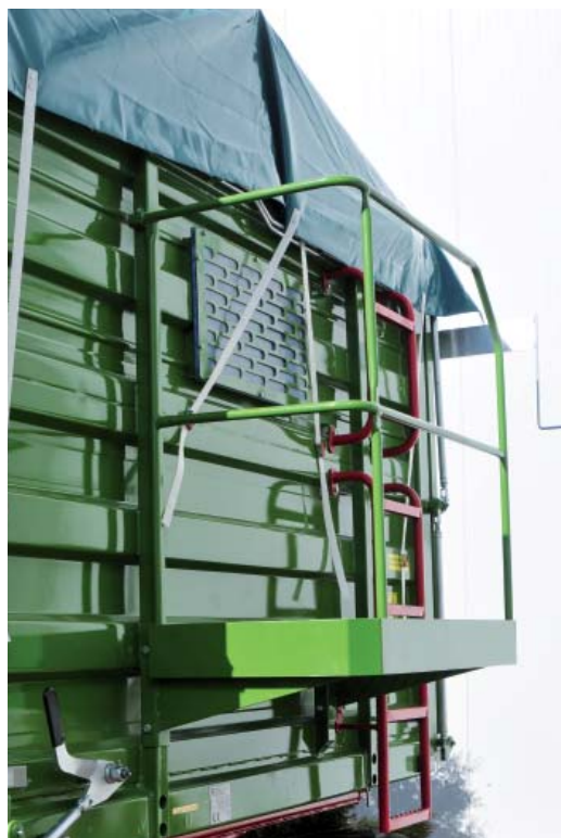
Okno wziernikowe w przedniej ścianie ułatwia kontrolę poziomu załadowania przyczepej
