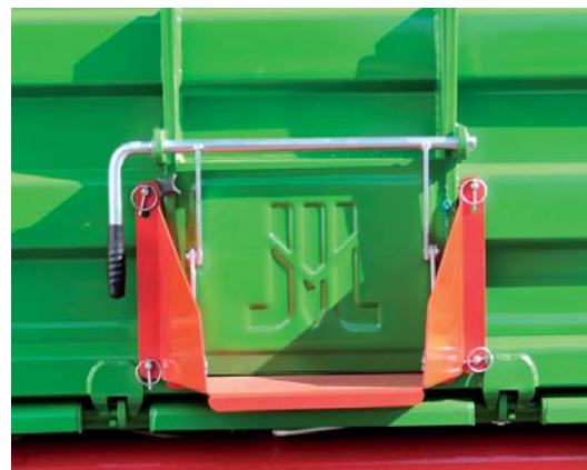
Okno zsypane w tylnej ścianie pozwala na workowanie materiałów sypkich lub montaż przenośnika ślimakowego
