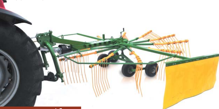
Zgrabiarki karuzelowe PRONAR posiadają trzy szerokości robocze 3,0 m, 3,5 m oraz 4,2 m
